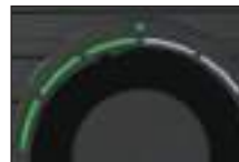
„Purifier” (Légtisztító) módban a LED-ek zölden világítanak.
