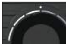
U načinu rada "Hybrid" LED lampice svijetle bijelo
