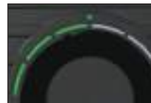
i driftstypen "Purifier" (Luftrensing) lyser LED-ene grønt
